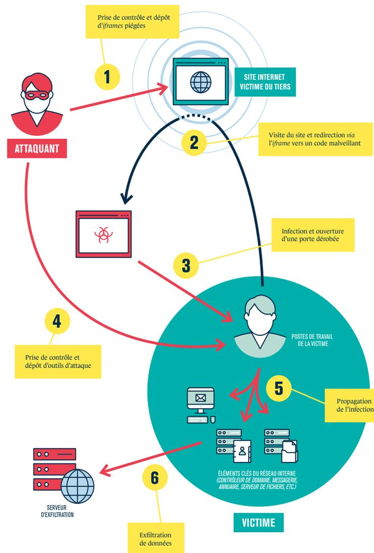
Figure 4 — Illustration d'un schéma d'attaque dit par « point d'eau »
